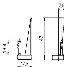
**Zugentlastungsbügel** für Leitungen ø 6 - 10
