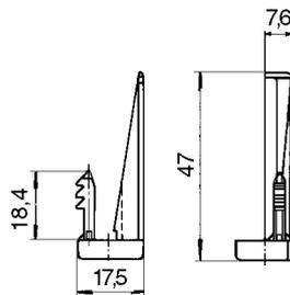
Zugentlastungsbügel für Leitungen  $\varnothing$  6 - 10
